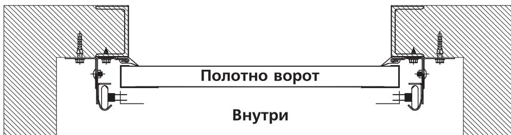
При невозможности установки металлического обрамления проема крепление ворот следует производить при помощи стяжных шпилек.
