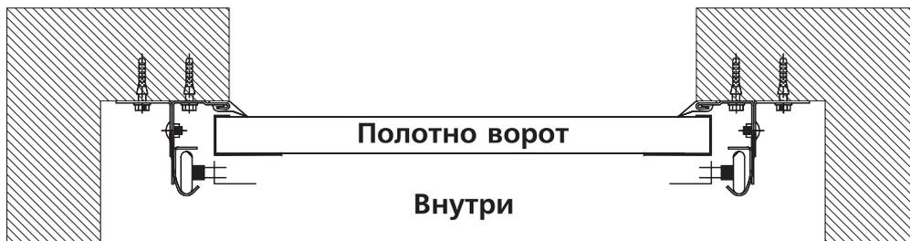
При выполнении несущих строительных конструкций из пустотелых материалов, таких как эффективный кирпич (пустотный керамический и силикатный кирпич) или камни керамические щелевые и камни силикатные, а также из ячеистых бетонов (газо- и пенобетон, газо- и пеносиликат) и газосиликатных блоков рекомендуется проем оформлять конструкцией из металлического фасонного профиля.
